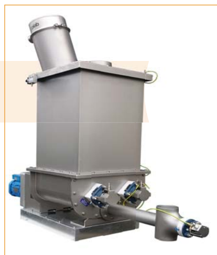
Precision PTF-500 feeder gravimetrische opstelling.
