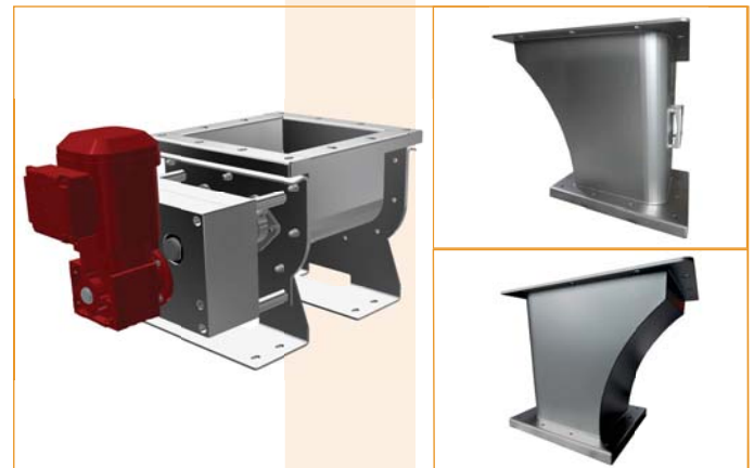
Precision PTF-250 Rechts afgebeeld TMF-trechter 30 liter De TMF-hopper is speciaal ontworpen voor zeer slecht stromende producten. Door het unieke asymmetrische ontwerp is de trechter over zijn gehele lengte lossend waardoor brugvorming boven de doseerkamer geminimaliseerd is. En er een optimale toevoer gegarandeerd is naar de doseerkamer.
