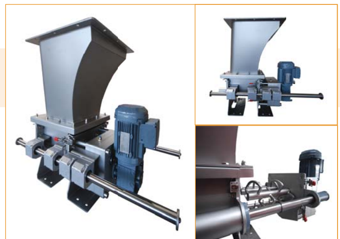
Uitvoering PTFs-250. Deze uitvoering is uitermate geschikt bij bedrijven waar meerdere productwissels per dag voorkomen. Door de geleidestangen kan de aandrijving met het gehele binnenwerk gemakkelijk uit de doseerkamer genomen worden voor inwendige reiniging welke droog of nat uitgevoerd kan worden.
