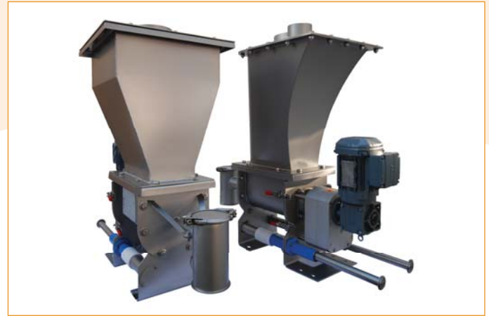
Precision centre feeder PCF170 uitgevoerd met standaard 30 liter trechter en een 30 liter mass flow trechter (Centre mass flow trechter (CMFT-30liter) Door het unieke asymmetrische ontwerp is de trechter over zijn gehele lengte lossend waardoor brugvorming boven de doseerkamer geminimaliseerd is.
